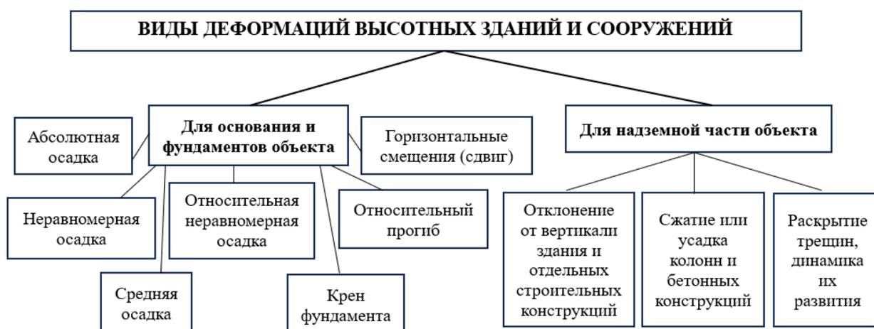
Рисунок 1.7 - Виды деформаций высотных строений
